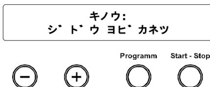
3. 確認のためにキー (P) を押してください。ディスプレイは設定された最新のオプションが表示されます、例えば、ヨビカネツハイ。
