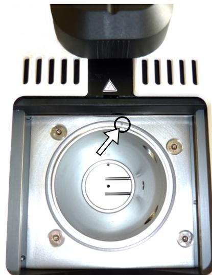
図 15: 溝の底にある換気用の穿孔
