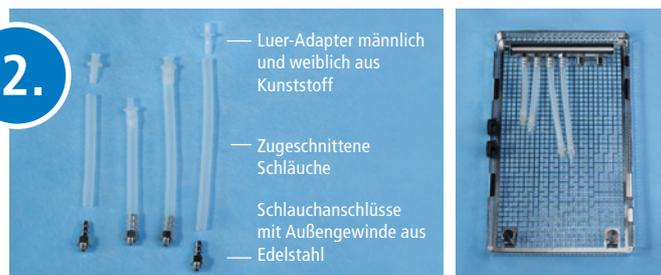
Zur Konfiguration der Schlauchanschlüsse für das Phako-Handstück und die Saug- und Spülhandgriffe wird der mitgelieferte dünnere Schlauch in Übereinstimmung mit der Darstellung in Abbildung 4 zugeschnitten.
