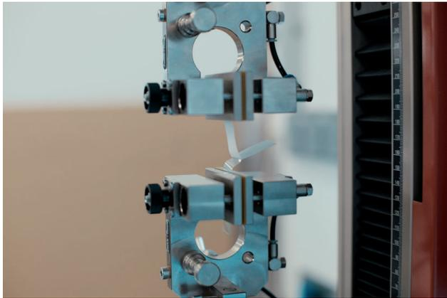
Die Siegelnahtfestigkeitsprüfung ist ein genormtes Prüfverfahren und stellt einen Teil der EN ISO 11607-2 zur Validierung von Verpackungsprozessen dar. Die jährliche Routinekontrolle auf Zugfestigkeit der Siegelnähte dient der Leistungsqualifizierung von MELAG Siegelgeräten und wird gemäß der EN 868-5 durchgeführt.
